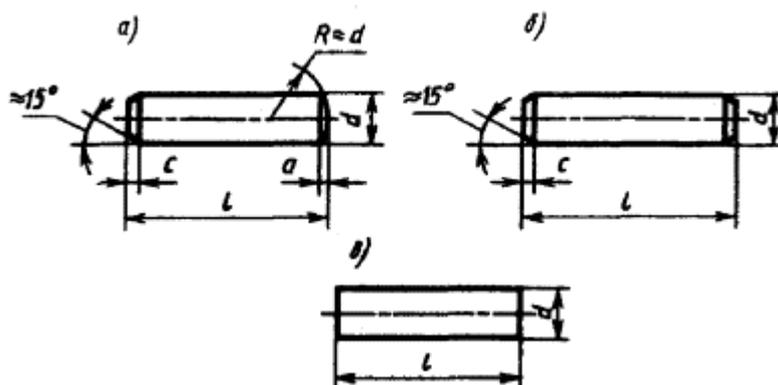
а - исполнение 1 (класс точности А); б - исполнение 2 (класс точности В); в - исполнение 3 (класс точности С)
